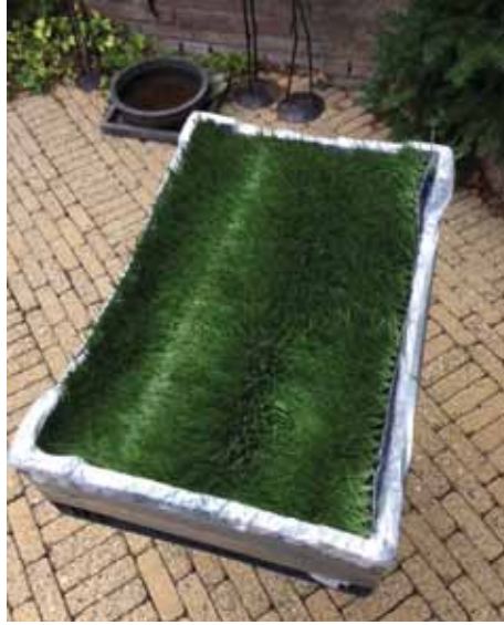
Daar bovenop kunstgras met een waterdoorlatende backing
