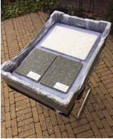
Op de krat een drukverdeeldoek met daarop diverse soorten shockpads
